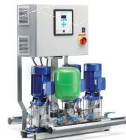
Frekventno regulisani booster sistemi su veoma efikasni. Pumpe uvek rade tako da prema trenutnom potrebnom protoku što obezbeđuje uštede do 25%. Takođe, pošto pumpe ne rade konstantno pri maksimalnom broju obrtaja, stvara se manja buka.
